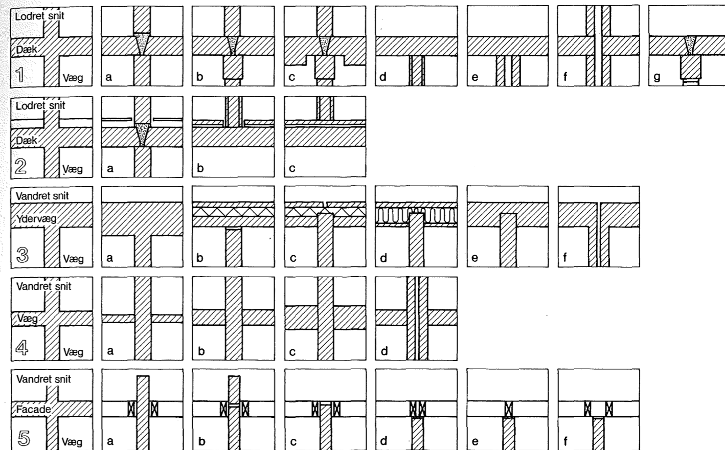
Figur 27. Skitse af samlinger mellem vægge og dæk, samt en række detaljer af samlingsudførelser, hvoraf de fleste er relativt hyppigt forekommende i dagens byggeri. Skitse 1 illustrerer samlinger mellem vægoverside og
